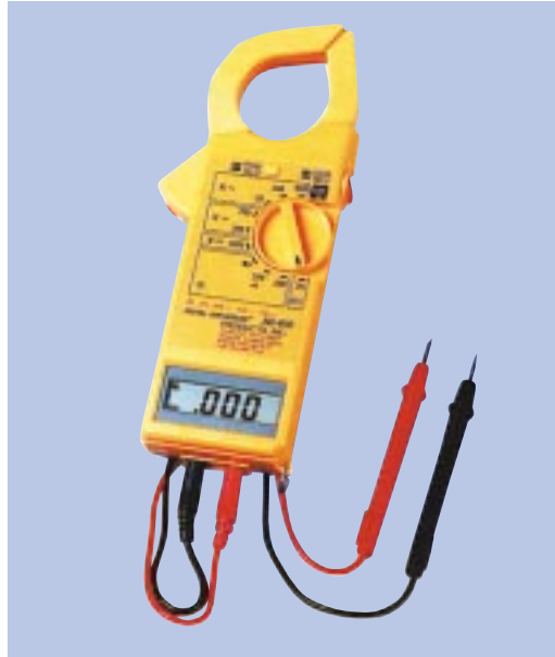
Σχήμα 2.10 Αμπερόμετρο με σιαγόνες σύσφιξης
