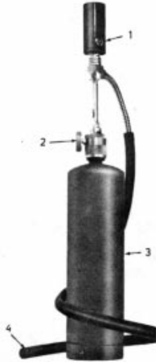
Σχήμα 18.3 Λυχνία ανίχνευσης διαρροών Halide
