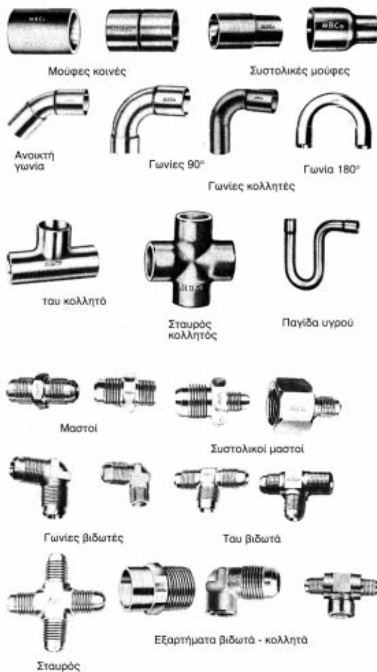
Σχήμα 12.1 Ειδικά εξαρτήματα συναρμολόγησης χαλκοσωλήνων
